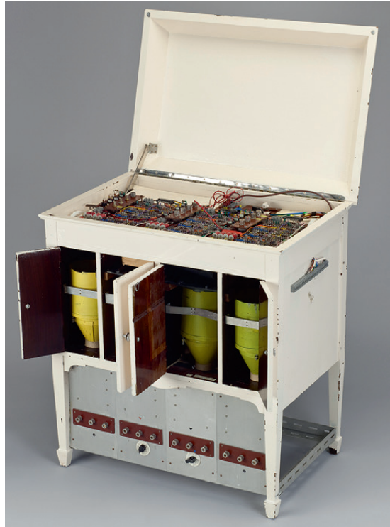
128 Daphne Oram und Graham Wrench: Bauteil des Oramics- Synthesizers zur optischen Klangsynthese ( timbre scanning unit ), 1964–66
